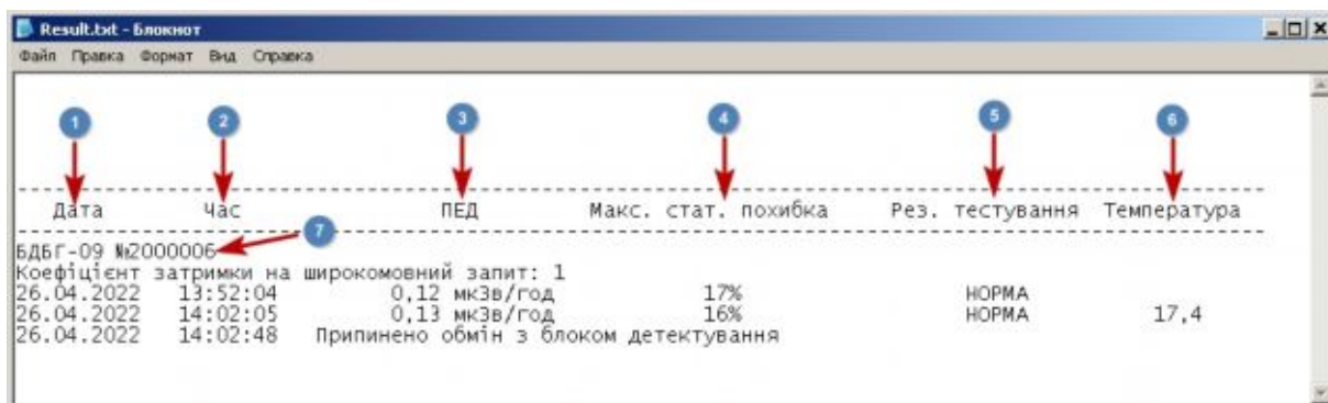
Рисунок 7. Структура файлу з результатами вимірів. 1, 2 – дата та час вимірювань; 3 – поточне значення потужності еквівалента дози гамма-випромінювання; 4 – максимальна статистична похибка; 5 – рядок повідомлення про перевищення встановленої норми ПЕД; 6 – значення температури; 7 – заводський номер детектора
