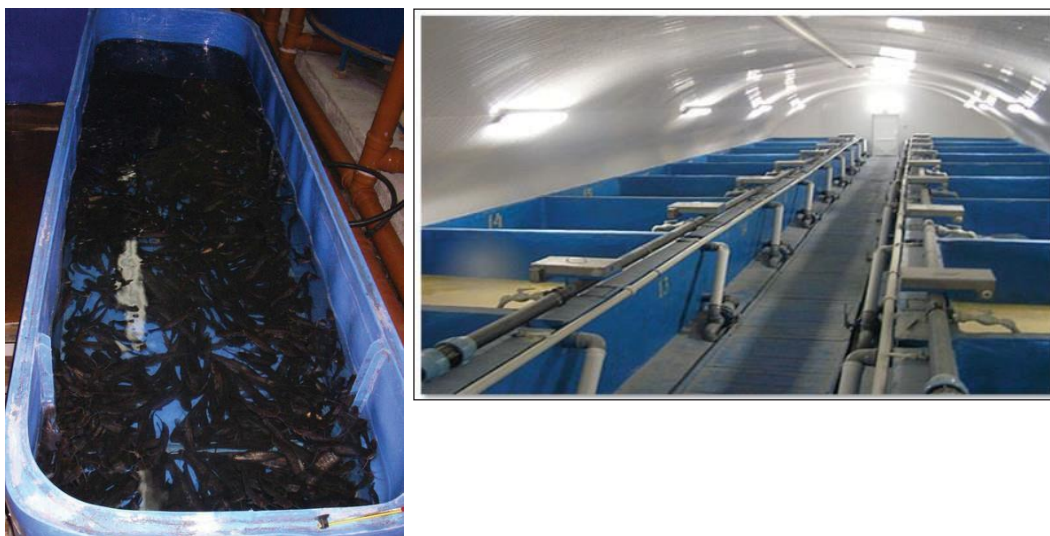
Рисунок 7.3, 7.4 – Вирощування сома в установці замкнутого водопостачання
