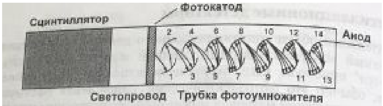
Рис.1.2 - Схема сцинтиляційного методу реєстрації іонізуючого випромінювання.
