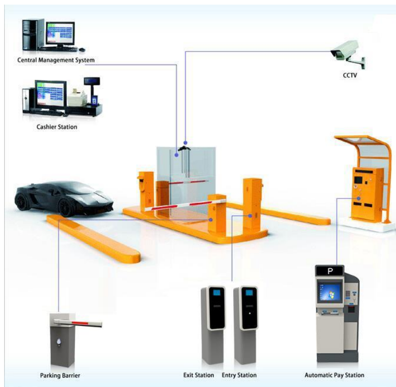
Рисунок 1 – Система автоматичного паркінгу.
