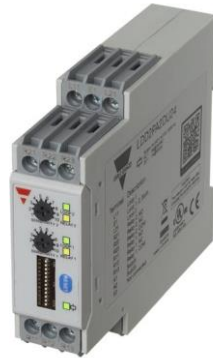
Рисунок 8 – Індуктивний детектор присутності транспортного засобу LDD2PA2DU24.
