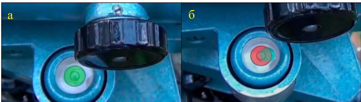
Рисунок 2.13 – Результати перевірки круглого рівня нівеліра: а – умова виконана; б – умова не виконана
