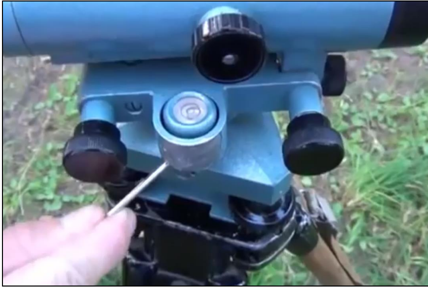
Рисунок 2.14 – Виправлення (юстування) круглого рівня за допомогою шпильки
