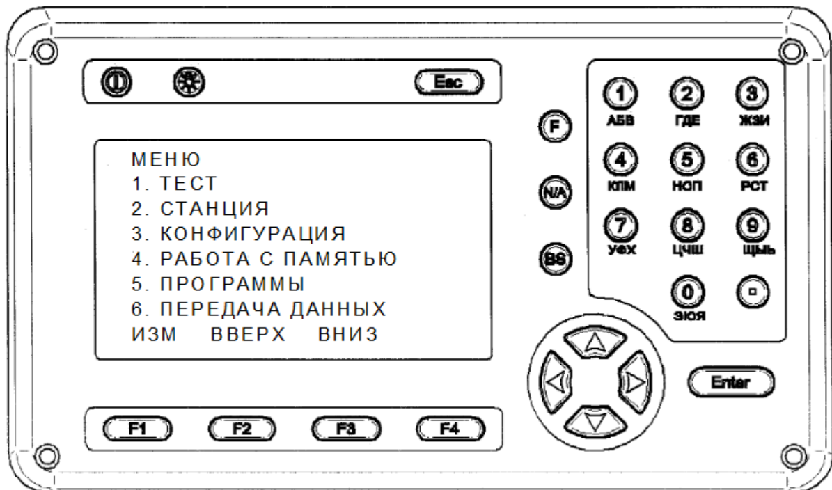
Рисунок 9.9 – Дисплей і клавіатура електронного тахеометра 5Та5: ⊕ – клавіша включення/виключення приладу; ⊙ – клавіша введення точки; ☀ – клавіша підсвічування дисплея; N/A – клавіша введення букв/цифр; Enter – підтвердження вводу, вибір підпрограм; Esc – відміна дії, перехід на ступінь вище у меню; BS – вилучення невірних набраних символів; F – клавіша програмування для виконання функцій; F1, F2, F3, F4 – клавіші програм для виконання різних функцій; 1, 2, 3, 4, 5, 6, 7, 8, 9 – клавіші набору цифр і букв; ◀ ▼ ▲ ▶ – клавіші переміщення курсору на дисплеї
