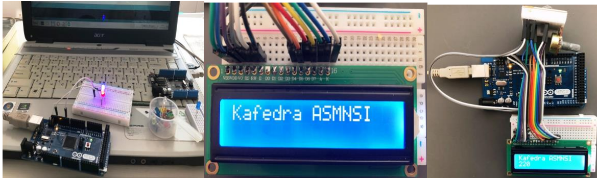
Рисунок 1 – Приклад роботи модулів мікропроцесору Arduino, що є частиною нового стенду для виконання лабораторних робіт
