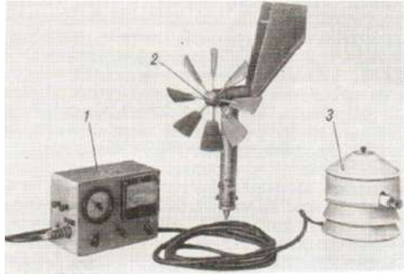
Рисунок 10 - Дистанційна метеорологічна станція ДМС-49: 1 – пульт керувально-вимірювальний; 2 – датчик швидкості напрямку вітру; 3 – датчик температури і вологості повітря.
