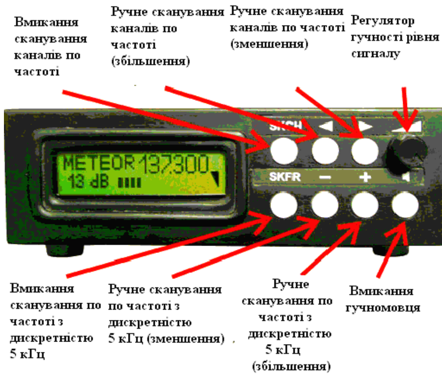
Рис. 10.3 – Зовнішній вигляд передньої панелі приймача
