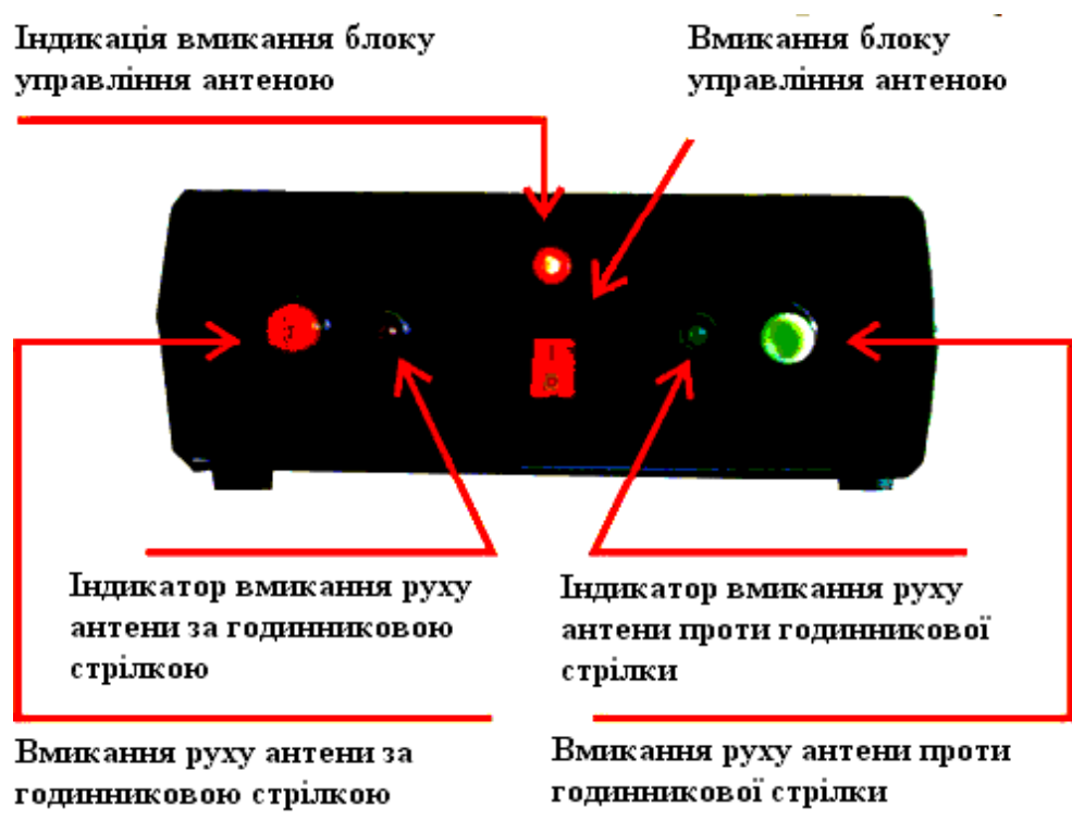
Рис. 10.4 – Елементи керування й індикації блоку керування антеною
